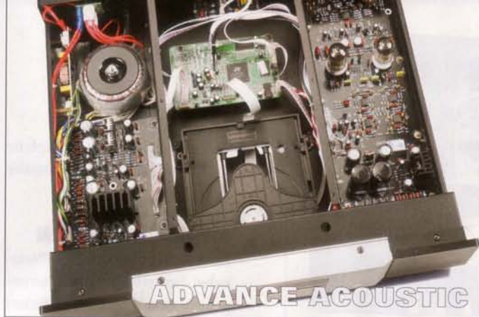
Sauber getrennt: Drei Kammern beherbergen Netzteil, Lauf- werk und Audio-Board (von links nach rechts) des MCD 203.
