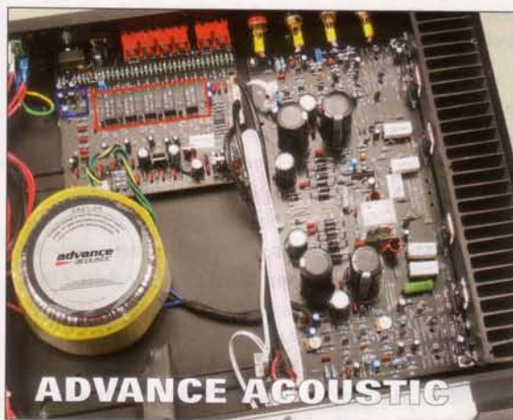
Üppig: MAP 103 mit fettem Trafo und Relais-Eingangs- wahl (rot). Die Phonostufe ist eher spartanisch (blau).
