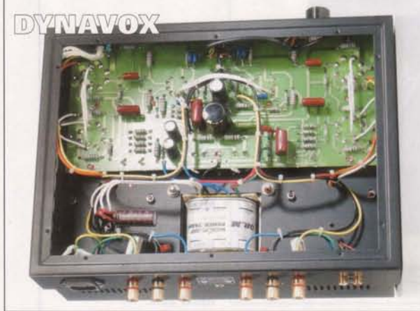
Nicht reinfassen: In Röhrenamps wie dem (sauber gebauten) VR-70 E droht Hochspannung – auch nach dem Ausschalten.
