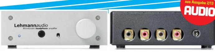
SCHLICHT, ABER SCHLAU: Der Kippschalter zwischen der Neutrik-Kopfhörerbuchse und dem Lautstärkeregler erlaubt es, Line-Ein-1 oder -2 aufzustellen, bei Bedarf dienen zwei Cinchbuchsen auch als Vorverstärkerausgang.
