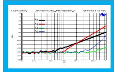
Mit einem Ausgangswiderstand von 5,7 Ohm kommt der Rhinelander mit jedem denkbaren Kopfhörer aus. Der anganz unten und oben einen klanglich nicht relevanten (oder höchstens günstigen) sanften Rolloff. Beim ingesamt bei größerer Leistung, was in der Regel zu einem dynamischen Eindruck führt.
