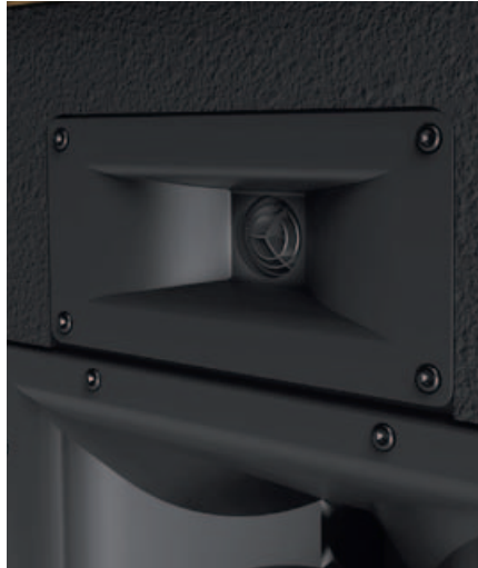
Beim Hochttonhorn formt der Phase-Plug die Wellenfront so, dass die Richtcharakteristik sehr frequenzunabhängig ist.
