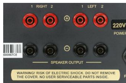
Anschlüsse für Lautsprecher nur als Banana-Buchsen, dafür aber in Bi-Wiring-Ausführung
