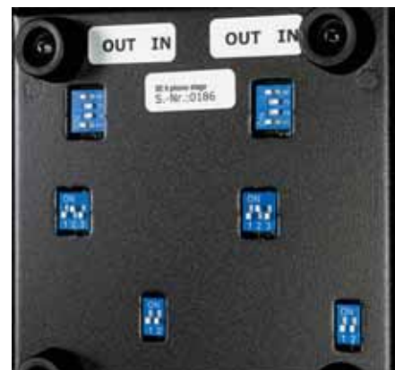
Jede Menge DIP-Schalter sorgen für optimale Anpassung an jeden Tonabnehmer. Perfekt: schaltbares Subsonic-Filter
