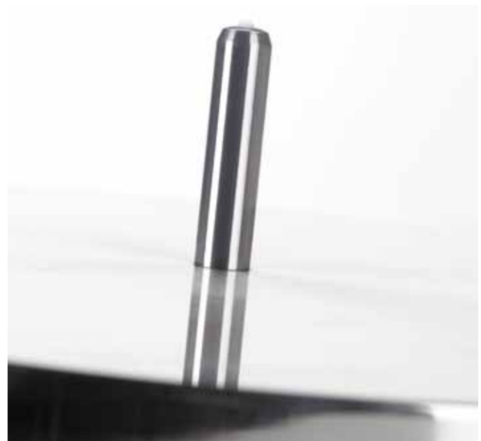
In der 12 Millimeter durchmessenden Tellerachse ist eine Keramik-Kugel fest eingelassen. Sie läuft auf dem Lagerboden auf einem Teflonspiegel. Die Lagerbuchse ist mit dem Chassis verschraubt.
