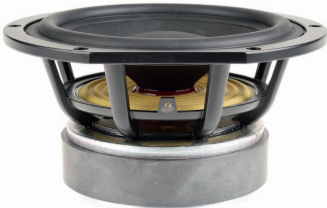
Die Bässe verfügen jetzt über noch stärkere Magnete und eine neue Schwingspule. Alle drei Basstreiber pro Box spielen parallel bis 310 Hz. Die Magnete der Treiber werden rückseitig von Gummis bedämpft, die an von der Hinterwand des Gehäuses kommenden Verstrebungen angebracht sind.
